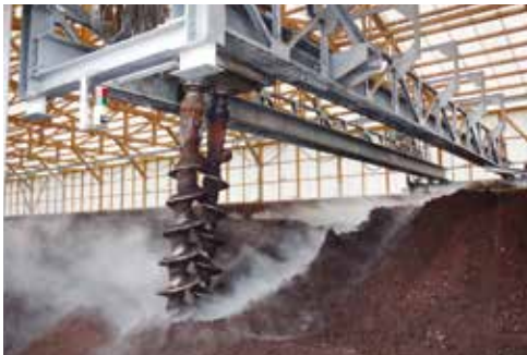
TM2軸スクリー式 TM 片懸垂式発酵攪拌機 3000H TM 2-axis type. TM half-suspensory agitator / height 3000mm
