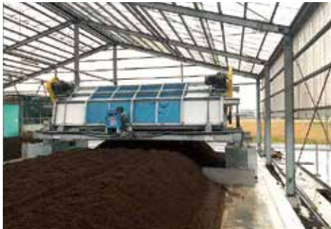
TM ロータリー攪拌機 自走式 5巾-1000H TM rotary type agitator Agtation width 5m / height 1000mm
