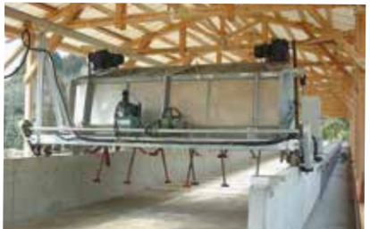
TM ロータリー攪拌機 1000H TM rotary type agitator / height 1000mm
