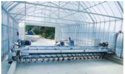
TM ロータリー攪拌機 1000H TM rotary type agitator / height 1000mm
