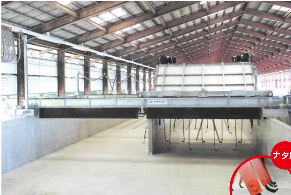
TM ロータリー攪拌機2連トラバーサー(ナタワタイプ) 5巾-2000H×2 TM Rotary Agitator Double traverser (machete claw type) Agtation width 5m / height 2000mm×2
