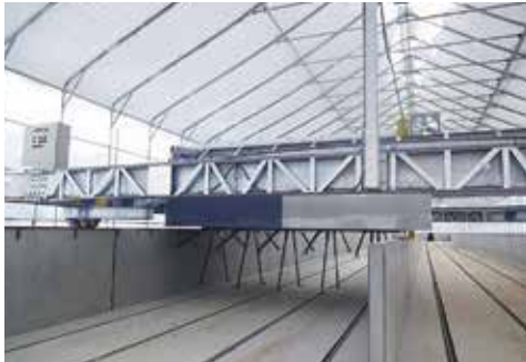
TM ロータリー攪拌機 エンドレス 5巾-1500H×2 TM rotary type agitator. EndlessAgtation width 5m / height 1500mm × 2
