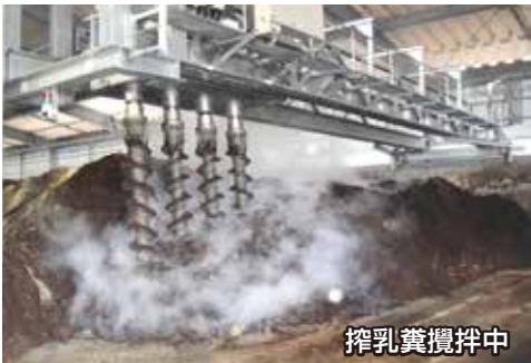
TM4軸スクリー式 TM 片懸垂式発酵攪拌機 3000H TM 4-axis type. TM half-suspensory agitator / height 3000mm
