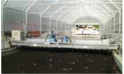
TMロータリー攪拌機 (畜糞乾燥攪拌機) TM rotary type agitator (Livestock dung drying agitator)
