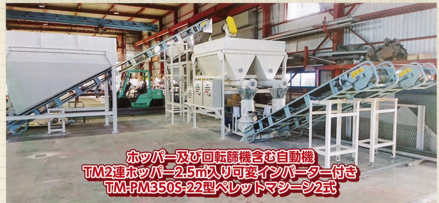
製品投入2連ホッパー2.5m 3 入り可変インバーター付き TM-PM350S-22型2式ペレットマシーン付き
