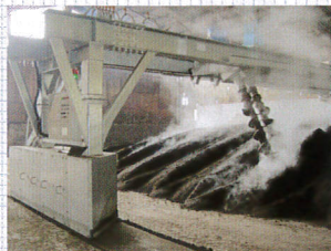
福岡県・肥育牛糞攪拌発酵中
