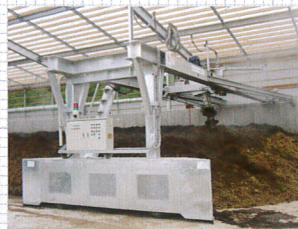
北海道御武町・搾乳糞攪拌発酵中
