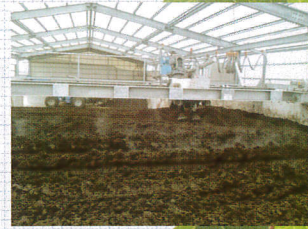
鹿児島県・搾乳糞攪拌発酵中
